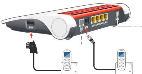
Schließen Sie ein analoges Telefon, Fax oder einen Anrufbeantworter an eine der „FON“-Buchsen an.
