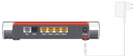
Schließen Sie die FRITZ!Box am Strom an. Die LED „Power / DSL“ beginnt zu blinken.
